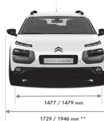
\* Breite des Fahrzeugs / Breite des Fahrzeugs inkl. Aussenspiegel
